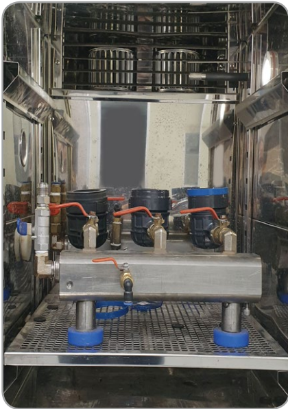
PPS 수도미터 동파방지 테스트 과정
