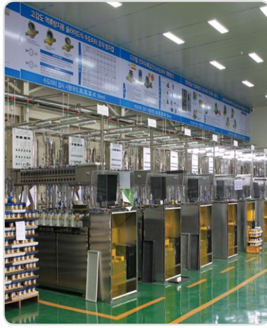
전자동 수도미터 시험 검사대 1,6배두 100~200배율 계량 기능공사(15~50mm)
